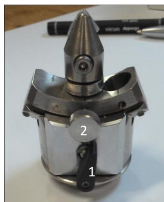
Figure 5 : Vue du mors positionné dans le porte-échantillon. Levier de verrouillage rotation (1) ; molette de serrage du mors (2) ; molette de rotation (pas montré car à l'arrière, 3)
