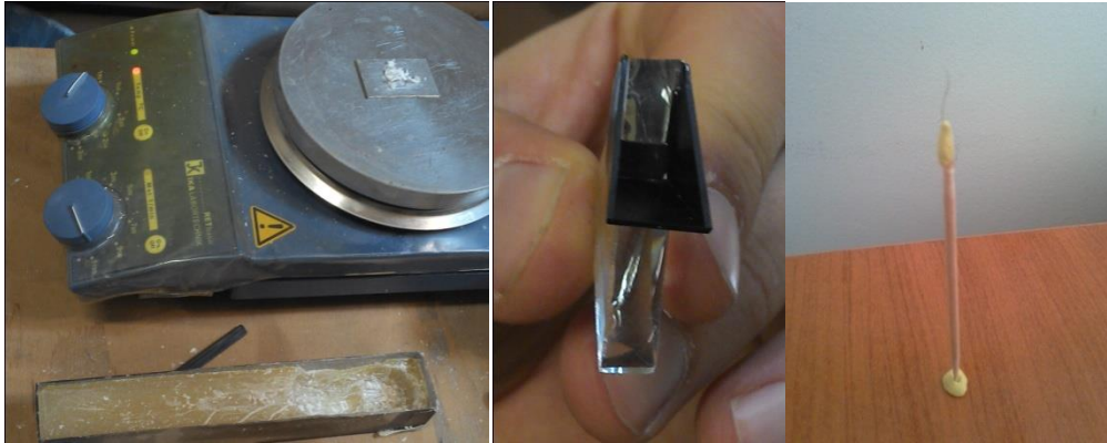
Figure 13 : plaque chauffante et cire (gauche) ; bateau monté sur un couteau de verre (centre) ; porte-cil artisanal (droite)
