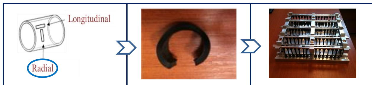
Figure 14. Prélèvement des éprouvettes d'élastomère industriel et mise en place pour les essais de vieillissement thermique en étuve ventilée.
