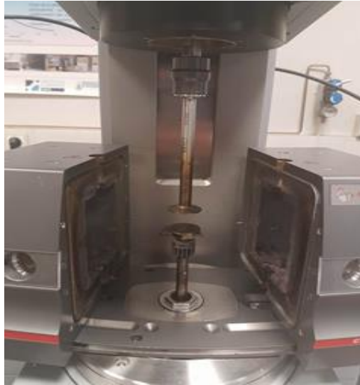
Figure 2.13 : Rhéomètre Anton Paar MCR502 utilisé pour les mesures rhéologiques
