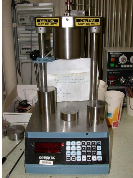
Figure 2-12. Fluidimètre KAYENESS utilisé pour cette étude.
