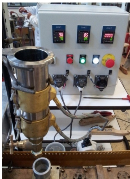
Figure 2.11 Dispositif « burette chauffante » et son module de chauffe
