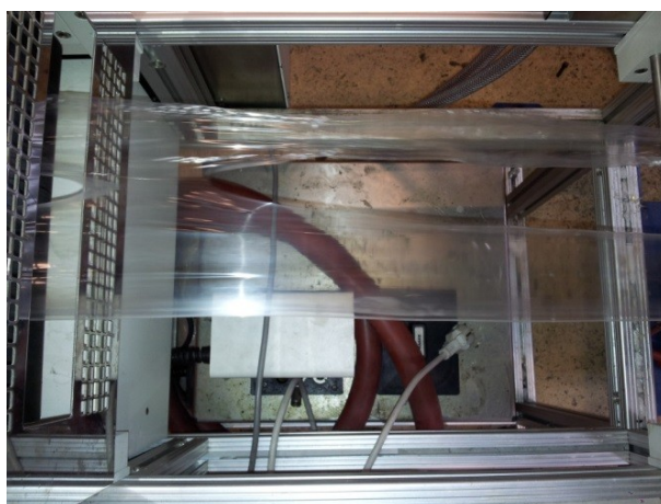
Figure 2.21 Calandrage d'une feuille [90 %m (PLA 4060D + 10 %m CDHP) + 10 %m PHI 002] obtenue par extrusion monovis « procédé dryblend » en présence d'infondus PHBV
