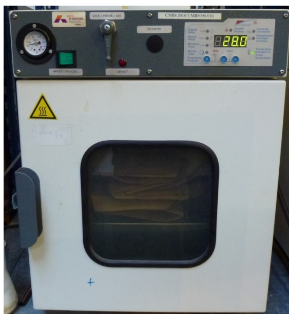
Figure 2.26 Etuve FisherBrand utilisée pour le vieillissement des bandelettes de PLA 4060D
