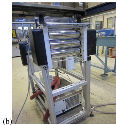
Figure 2.16 (a) Filière plate 200 mm et (b) Calandreuse
