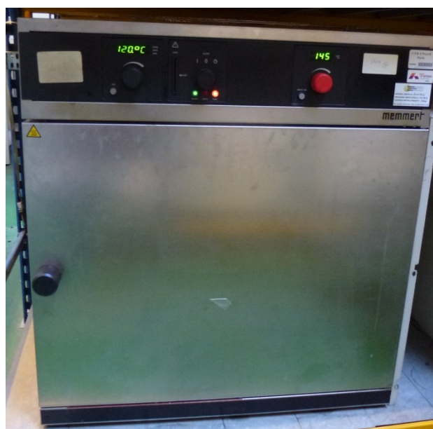
Figure 2.25 Etuve Memmert utilisée pour la cristallisation du PLA 4042D
