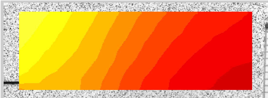
Figure III.21: Champ de déplacement vertical mesuré
