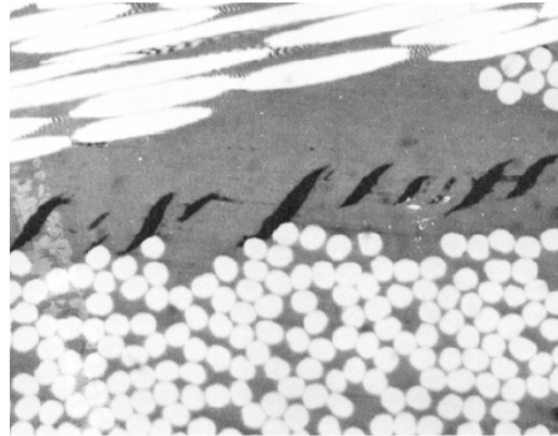
Figure II.22: Microfissures orientées à 45^\circ du plan de rupture (mode II) [SMITH 1993]
