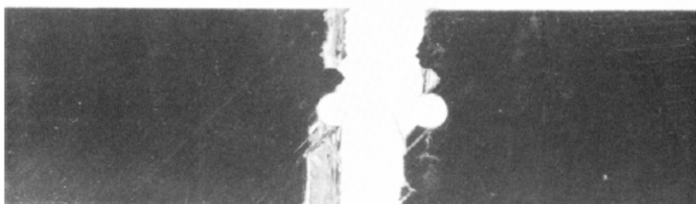
Figure I.3: Ruptures par traction de différentes séquences d'empilement: (a) 0^\circ/90^\circ tissu, (b) unidirectionnel, (c) Quasi-isotrope trouée, (d) 0^\circ/90^\circ trouée [SMITH 1993]
