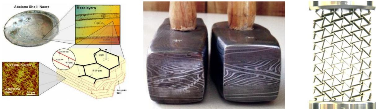
Figure 1 : Exemples de matériaux architecturés, nacre (gauche), acier damassé (centre), treillis auxétique (droite).
